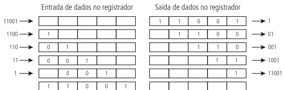
Figura 7.2: Entrada e saída de dados de um registrador série-série
