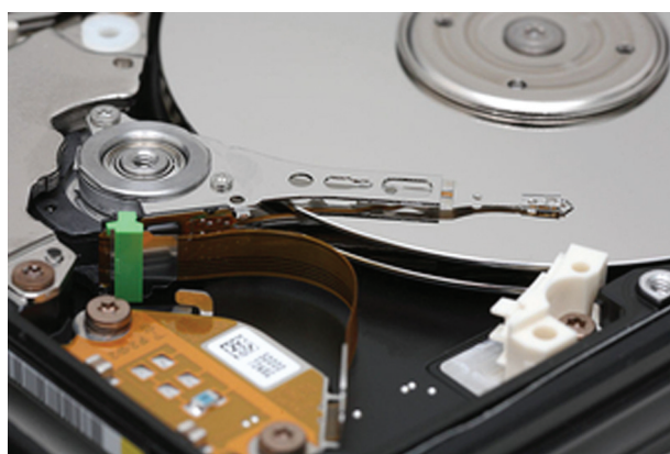
Figura 3.11: HD sem a tampa de proteção
