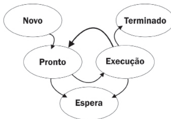
Fig. 4.3 – Diagrama de estados de um processo
